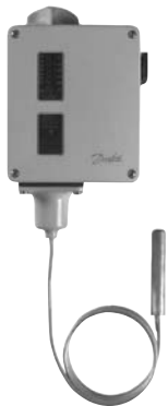
RT 106 mit zylindrischem Fernfühler, Deckel mit Fenster und Knopf für Handeinstellung
