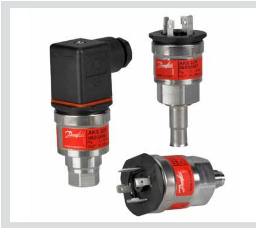
L'AKS 32R est un transmetteur de pression ratiométrique qui convertit la pression mesurée en un signal de sortie linéaire. La valeur min. du signal de sortie est inférieure à 10 % de la tension d'alimentation réelle. La valeur max. est supérieure à 90 % de la tension d'alimentation réelle.
