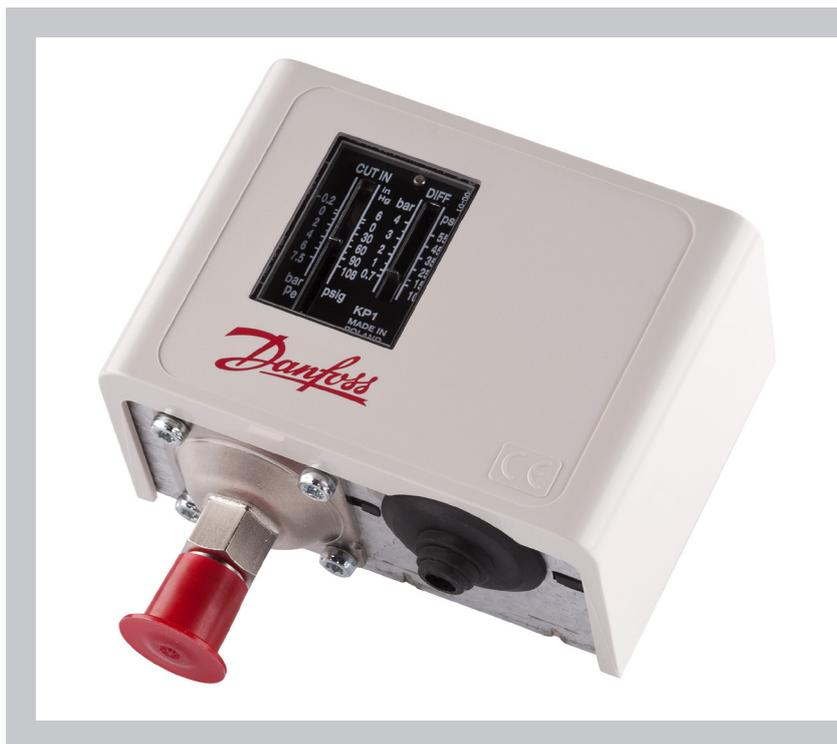
I pressostati KP sono utilizzati per proteggere gli impianti frigoriferi o di condizionamento aria da pressioni di aspirazione eccessivamente basse o pressioni di mandata eccessivamente elevate.
