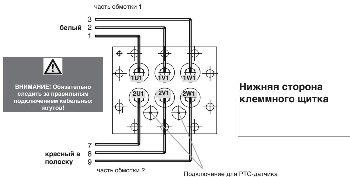
Распайка выводов на клеммном щитке с переключением со звезды на треугольник (Y/Δ)
