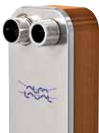
CB60 — меднопаяный пластинчатый теплообменник. Припой надежно соединяет пластины в точках контакта и уплотняет пакет пластин, что обеспечивает оптимальный КПД теплопередачи и позволяет поддерживать высокие давления внутри теплообменника.
