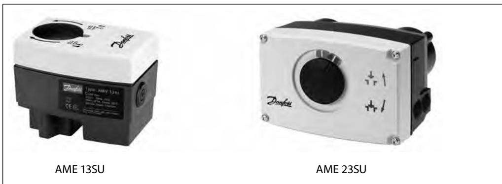
Электроприводы предназначены для управления регулирующими клапанами VZ и VZL (AME 13SU), VS2, VM2 и VB2. Функция безопасности (возвратная пружина) активируется при обесточивании привода или подаче сигнала с термостата защиты. Шток привода пружиной втягивается. Приводы автоматически подстраивают ход своего штока под ход штока клапана, что снижает время введения клапана в эксплуатацию.
