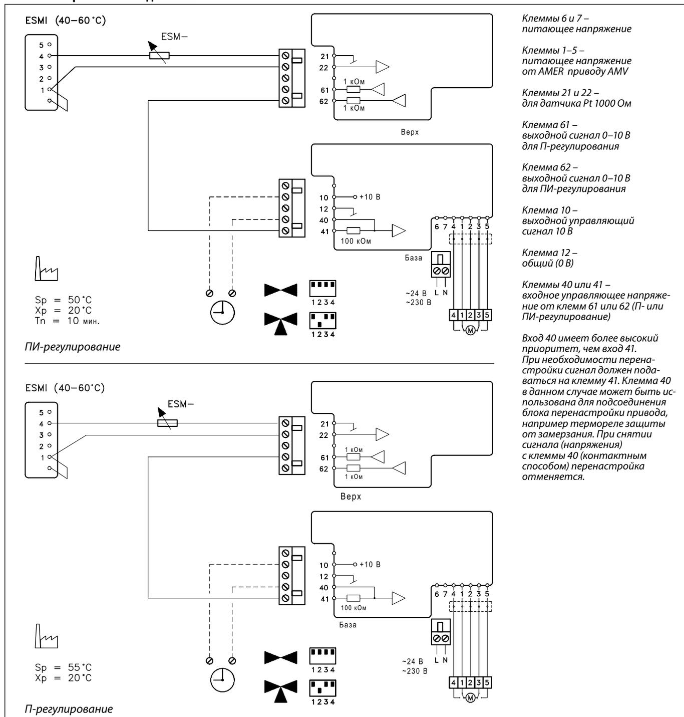
Схема электрических соединений
