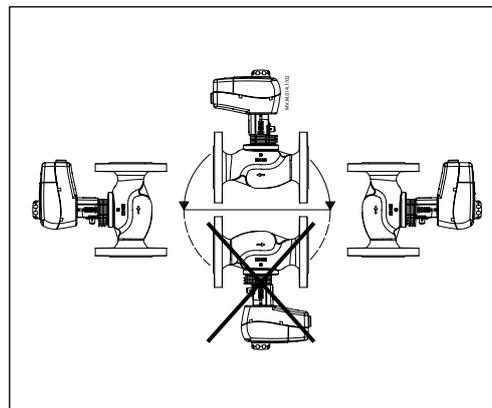
Электропривод может быть повернут вокруг оси штока клапана в удобное для обслуживания положение (на 360°), после чего он должен быть зафиксирован на клапане стопорными винтами.
