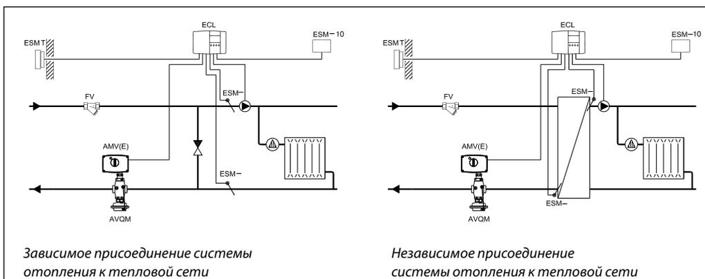
Установка клапана на подающем трубопроводе
