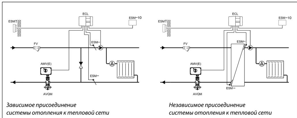
Установка клапана на подающем трубопроводе
