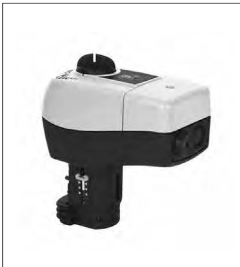
Данный электропривод предназначен для управления двух- и трехходовыми регулирующими клапанами VF3, VL2, VL3 условным проходом до 80 мм и клапанами серий VRB, VRG. Приводы имеют концевые моментные выключатели, прекращающие их работу при возникновении перегрузок, а также при достижении штоком клапана крайних положений.
