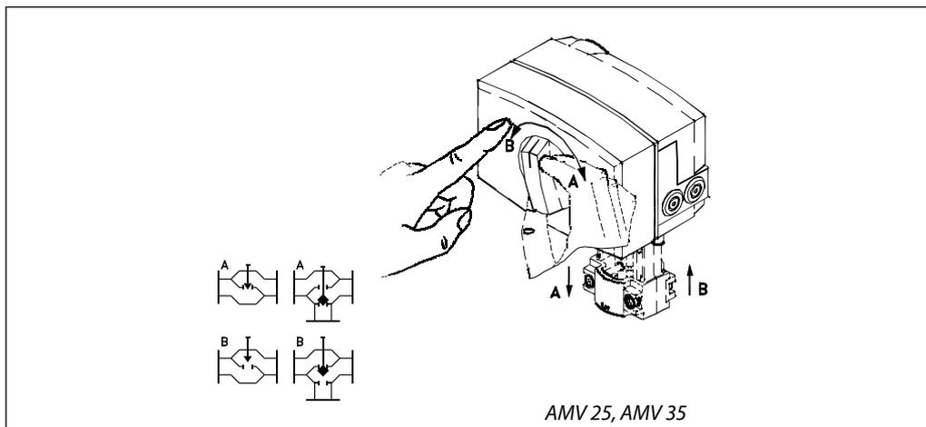
Ручное позиционирование производится поворотом рукоятки до нужного положения. Проверить правильность направления вращения шпинделя.
