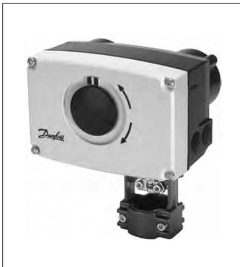
Электроприводы AMV 25SD и AMV 25SU предназначены для управления регулирующими клапанами VF3 и VFS2 с условным проходом до 50 мм. При обесточивании в зависимости от типа привода возвратная пружина выдвигает или втягивает его шток. Приводы автоматически подстраиваются под крайние положения штока клапанов.
