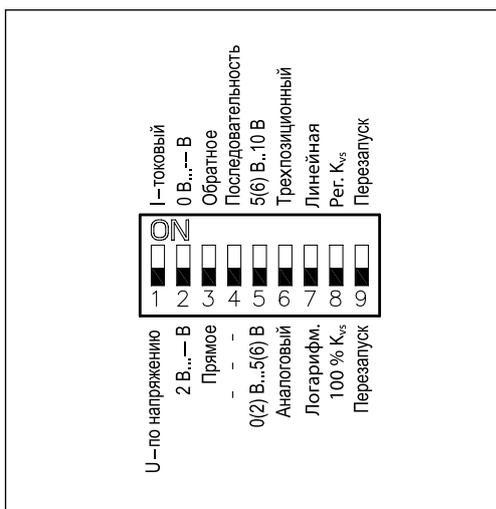
Электропривод оснащен блоком микропереключателей выбора функций DIP, который находится под съемной крышкой.
