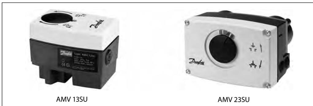
Электроприводы AMV 13SU и AMV 23SU с функцией безопасности предназначены для управления регулирующими клапанами VZ и VZL (AMV 13SU), VS2, VM2, VB2. Возвратная пружина втягивает шток приводов при их обесточивании. Электроприводы автоматически подстраиваются под крайние положения штока клапанов.
