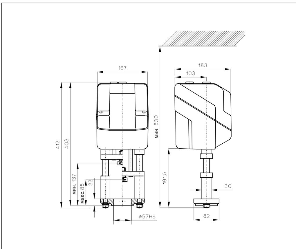
Комбинации электроприводов и регулирующих клапанов
