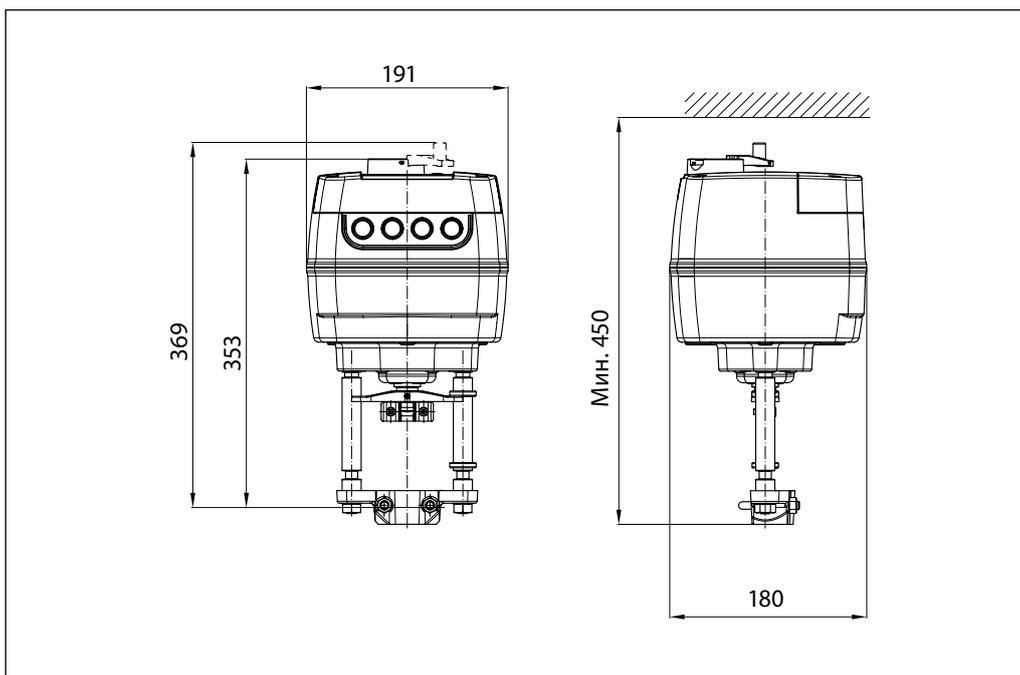
**Комбинации электроприводов и регулирующих клапанов**
