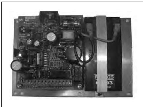
AM-PBU 25 является источником резервного питания для приводов с питающим напряжением 24 В. Он используется как «электронная возвратная пружина».
