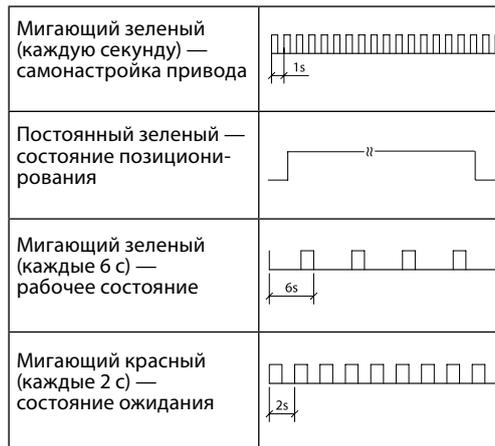
**Режимы STAND-BY, RESET и LOCK MODE для редукторного электропривода АМЕ 445**
