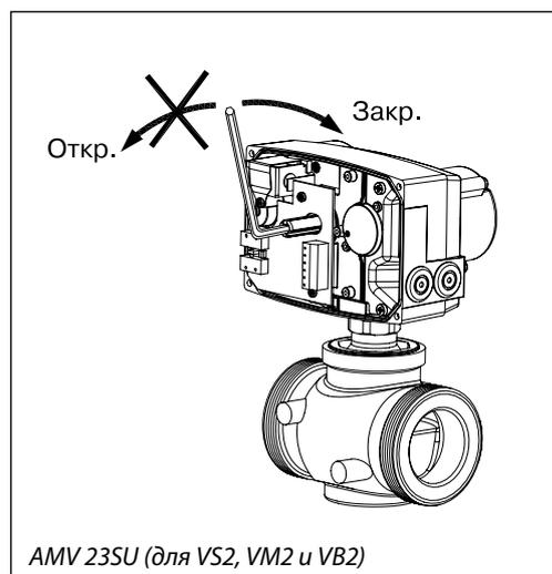
Ручное позиционирование производится при отключенном напряжении и снятой крышке. Вставить 6-мм (для AMV 13SU) или 5-мм (для AMV 23SU) шестигранный торцевой ключ (не входит в комплект поставки) в верхнюю часть шпинделя и поворачивать в сторону «от пружины».
