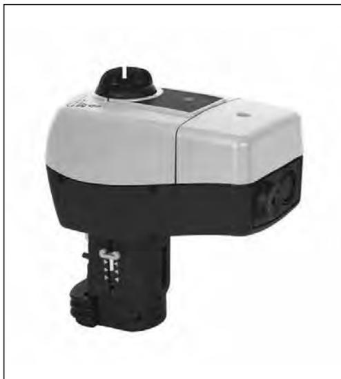
Электропривод предназначен для управления двух- и трехходовыми регулирующими клапанами VF3, VL2, VL3 условным проходом до 80 мм и клапанами серий VRB и VRG. Приводы имеют концевые моментные выключатели, прекращающие их работу при возникновении перегрузок, а также при достижении штоком клапана крайних положений.
