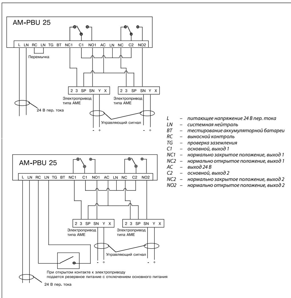
Перемычка между LN и RC может быть заменена подключением к системе диспетчеризации инженерного оборудования зданий (BMS), регулятором или ручным переключателем. Когда контакт разомкнут, подача напряжения от сети отключена (*building mains power*) и агрегат AM-PBU 25 проходит цикл, получая питание от аккумуляторной батареи. Данная функция может использоваться для выносного контроля регулирующего клапана или
