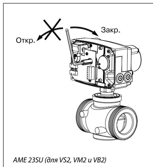
Ручное позиционирование выполняется при снятой крышке привода и отключенном питающем напряжении. Для позиционирования используется 6-мм (для AME 13SU) или 5-мм (для AME 23SU) торцевой шестигранный ключ (в комплект поставки не входит). Ключ вставляется в отверстие шпинделя привода и поворачивается в сторону противодействия пружины. При позиционировании следите за индикатором поворота. Чтобы закрепить положение шпинделя, необходимо зафиксировать ключ.
