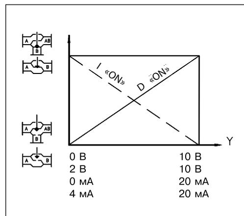
Электропривод оснащен блоком микропереключателей выбора функций DIP, который находится под съемной крышкой. В частности, если переключатель (6) поставлен в позицию «ON», электропривод начинает работать как трехпозиционный. Для подготовки привода к работе необходимо установить нужные положения переключателей.
