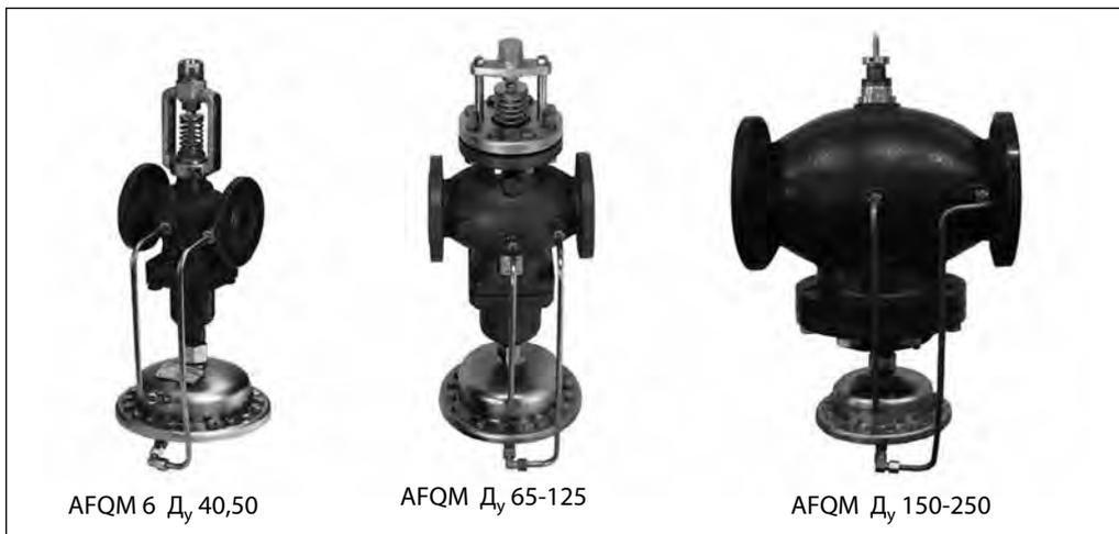
AFQM является моторным регулирующим клапаном с автоматическим ограничением предельного расхода для применения в системах централизованного теплоснабжения. Регулирующая диафрагма поддерживает на регуляторе-ограничителе расхода перепад давлений 0,2 или 0,5 бар. Клапаны типа AFQM используются с электроприводами в следующих сочетаниях:
