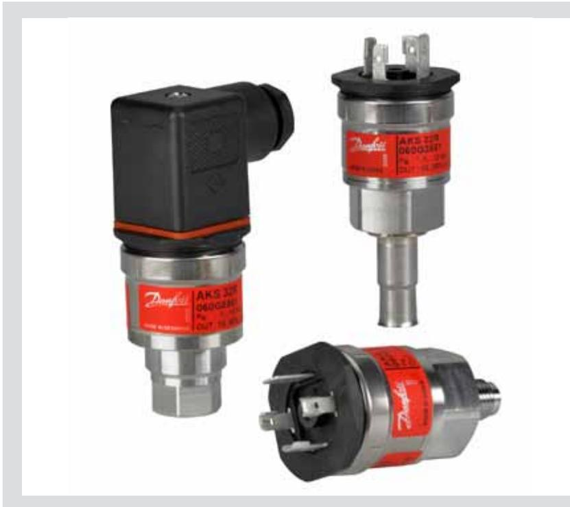
AKS 32R ist ein ratiometrischer Druckmeßumformer, der den gemessenen Druck in ein lineares Ausgangssignal umwandelt. Der Mindestwert des Ausgangssignals beträgt weniger als 10% der aktuellen Versorgungsspannung. Der max. Wert ist 90% der aktuellen Versorgungsspannung.
