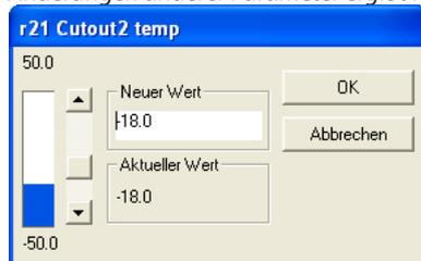
Den neuen Wert eingeben oder die Säuleneinstellung mit dem Mauszeiger nach oben oder unten ziehen. Der neue Wert gilt, wenn „OK“ geklickt wird.
