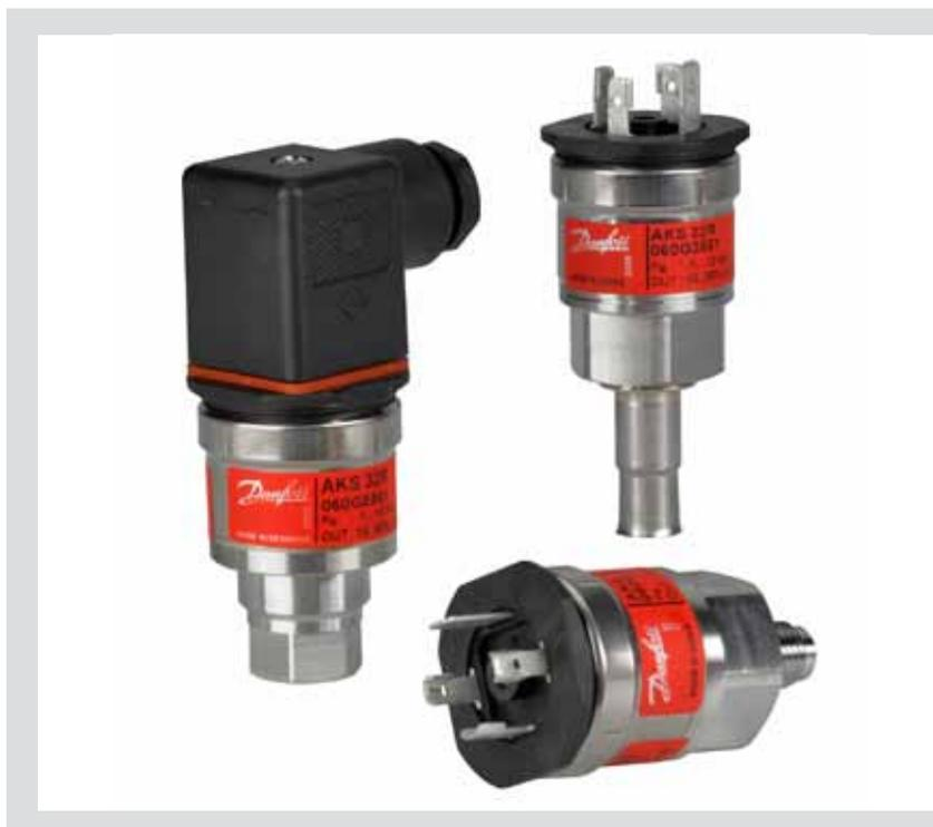
AKS 32R è un trasmettitore di pressione raziometrico che converte la pressione misurata in un segnale lineare in uscita. Il valore min. del segnale di uscita è inferiore al 10% della tensione di alimentazione effettiva. Il massimo è uguale al 90%.
