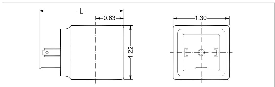
**Высокопроизводительные катушки типа BT**
