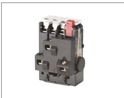
Il relè termico TI 9C-5 si utilizza con il minicontattore CI 5 per la protezione di motori con rotore a gabbia di scoiattolo nei casi in cui le dimensioni compatte sono un requisito importante. Il relè è dotato di protezione monofase, vale a dire assicura un intervento rapido nel caso di perdita di una fase. Ciò riveste particolare importanza nel caso dei motori con configurazione a triangolo.
