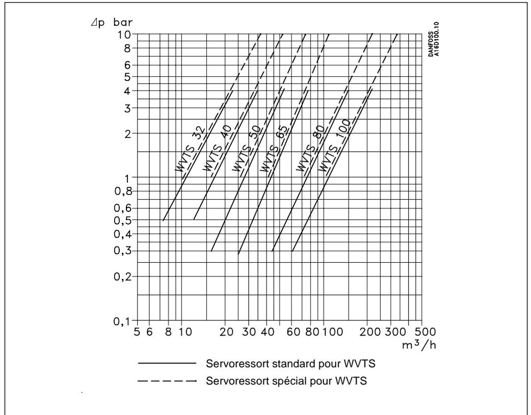
Les courbes de capacité représente la capacité (quantité d'eau en m³/h) des tailles de vannes individuelles en fonction de la chute de pression au sein de la vanne.
