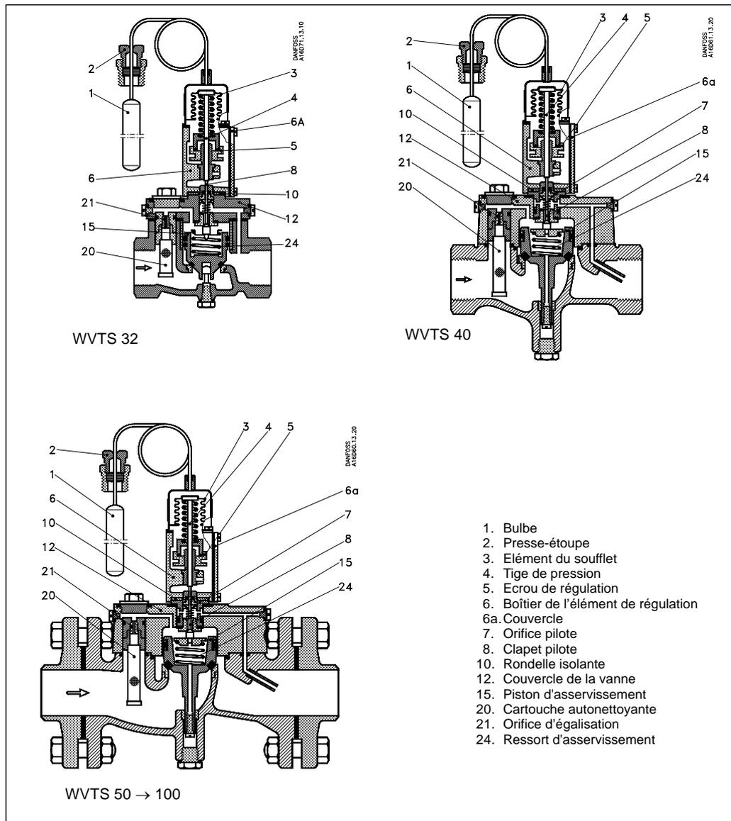
Le corps de vanne est en fer coulé et le siège en bronze.
