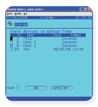
On accède à cette fonction de chargement par réfrigération/configuration/réglage régulateur. Une fois dans le réglage régulateur, le bouton chargement sera disponible. La page de chargement résultante permettra que tous les régulateurs, scannés et configurés dans le AK-SC255 E soient présents.
