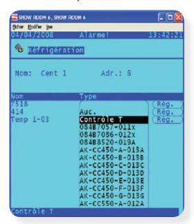
Pour régler des points de contrôle, suivre la méthode standard dans configuration de réfrigération - menu principal/Configuration/Réfrigération/ ajouter régulateurs. Répondre « non » à la question régulateur de centrale requis ? et naviguer dans la partie inférieure de l'écran et écrire combien de sondes de contrôle sont requises (toujours décrit comme nombre de régulateurs de postes).
