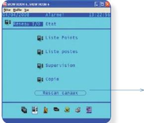
Il est possible d'avoir plusieurs réseaux vérifiés en une seule fois. Si on utilise SNMP soyez sûrs que la gamme de réseau IP est correcte et connue.
