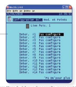
De l'écran « configuration/éclairage/modules et points », choisir le bouton réglage. L'écran de réglage va alors apparaître comme montré à droite ci-dessus. Pour chaque contacteur, il y a une liste déroulante avec le nom de la zone qui peut être assignée à ce contacteur. Choisir le nom de zone approprié pour chaque contacteur configuré et le réglage est alors complet. Retourner à la page configuration éclairage pour régler les points d'alarme si ceux-ci sont nécessaires.
