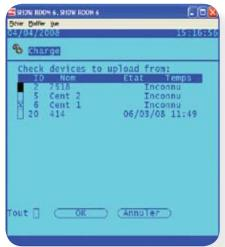
L'accès à la fonction de chargement se fait via le menu réfrigération/configuration/réglage régulateurs. Dans le menu réglage régulateurs le bouton chargement va apparaître. Vérifier que la touche tous ou all soit cliquée et vérifier que l'état de copie reflète la date et l'heure du téléchargement.
