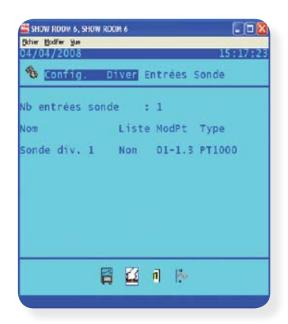
Dans cet exemple, en programmant le AK-SC255 E taper simplement 0127 et le format sera automatiquement réglé pour le module AK2 I/O.
