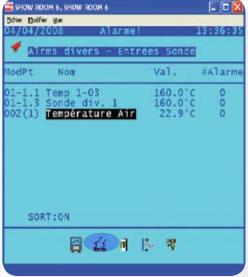
Choisir le paramètre « importé » et entrer dans le menu configuration alarme pour ce paramètre.
