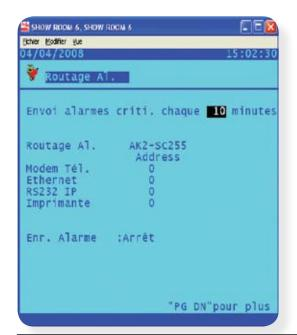
Choisir l'intervalle de temps pour laquelle une alarme critique sera retransmise (minimum 10 minutes).
