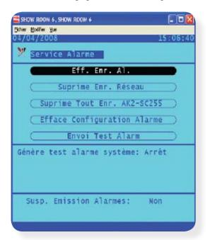
Utiliser le bouton test envoi alarme pour forcer un test alarme.
