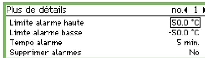
Les valeurs de l'image "Plus de détails" peuvent être modifiées à partir de l'unité de surveillance. Le nouveau paramètre est ressaisi dans le régulateur.
