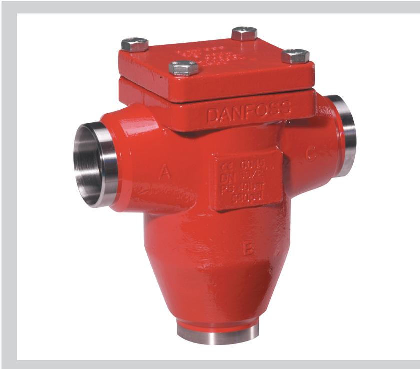
Регуляторы ORV — это трехходовые промышленные клапаны, предназначенные для поддержания постоянной температуры масла в газовых компрессорах (например, винтового или роторного типа) путем смешивания потоков горячего и холодного масла.
