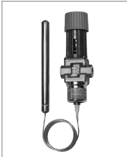
El uso de las válvulas termostáticas AVTA es muy frecuente para regular la temperatura en diversas máquinas e instalaciones en las que es necesario algún tipo de refrigeración. Las válvulas AVTA para agua de refrigeración siempre se abren para admitir caudal cuando aumenta la temperatura del sensor.
