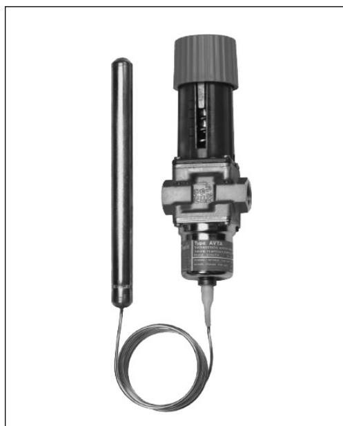
Le valvole termostatiche AVTA sono ampiamente utilizzate per la regolazione della temperatura in diversi tipi di macchine e installazioni, dove sia richiesto il raffreddamento. Le valvole raffreddamento AVTA si aprono all'innalzamento della temperatura del sensore.
