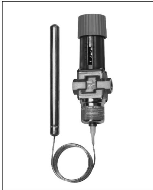
Die AVTA-Thermostatventile werden weithin zur Temperaturregelung in unterschiedlichsten Maschinen und Installationen mit Kühlbedarf eingesetzt. AVTA-Kühlwasserventile öffnen sich stets, um bei steigender Fühlertemperatur den Durchfluss zu ermöglichen.
