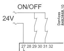
Si une sortie est affectée à un étage de capacité, il n'est pas nécessaire de connecter le circuit de sécurité annexe.
