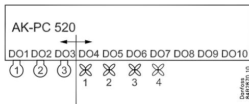
Si toute la capacité de condensation doit être réglée par un variateur de vitesse, l'AK-PC 520 doit émettre un signal analogique concernant la capacité désirée (« c29 » = 9).
