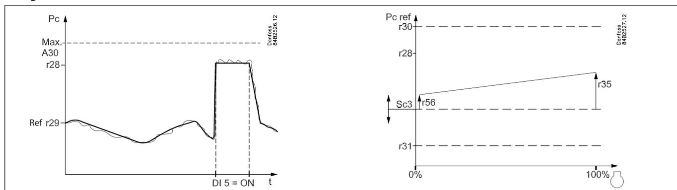
La référence suit la température extérieure Sc3. Si la température extérieure chute d'un degré, la référence en corollaire chutera d'un degré. La référence s'adapte à la capacité du compresseur avec une valeur max. Xp.
