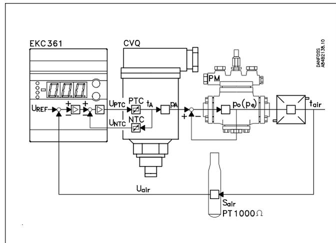
La temperatura ajustada en el actuador determina la presión de evaporación
