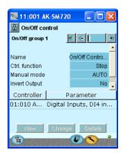
Les groupes qui sont créés via cette commande peuvent réunir les signaux d'une fonction on/off de tout régulateur du réseau. Ce signal est ensuite transmis vers une autre fonction on/off du réseau.
