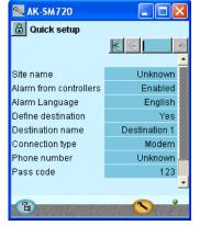
Dans ce menu, les réglages nécessaires sont rassemblés de façon à ce qu'un acheminement simple de l'alarme puisse être opéré. Tous les réglages seront transférés dans les autres écrans respectifs.
