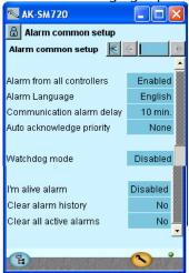
Réglez de façon à ce que des alarmes soient reçues de tous les régulateurs raccordés.
