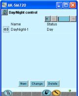
Les groupes créés par le biais de cette commande reçoivent en même temps le signal jour/nuit. L'activation du signal s'opère soit à partir d'un schéma et/ou à partir d'un contact.
