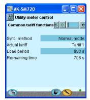
Cette fonction nécessitera un signal d'un compteur. La consommation peut alors être suivie dans les écrans affichés. Il est possible d'établir jusqu'à 8 mesures.
