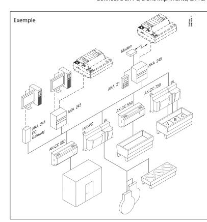
La commande de la passerelle et des régulateurs s'effectue à l'aide d'un logiciel type AKM (installation sur PC). L'AKA 21 permet de régler des fonctions individuelles dans la passerelle et peut être utilisée pour commander les régulateurs sur DANBUSS.
