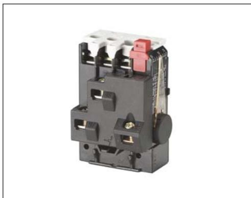
El relé de sobrecarga térmica TI 9C-5 se utiliza con el minicontactor CI 5, para protección de los motores de jaula de ardilla en los que es necesario compacidad. El relé dispone de protección monofásica, es decir, un mecanismo de disparo por aceleración en caso de desexcitación de la fase.
