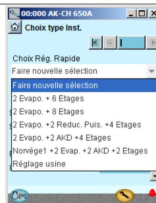
L'installation supérieure vous proposera un choix entre une série de combinaisons prédéfinies qui déterminent simultanément les endroits de raccordement.
